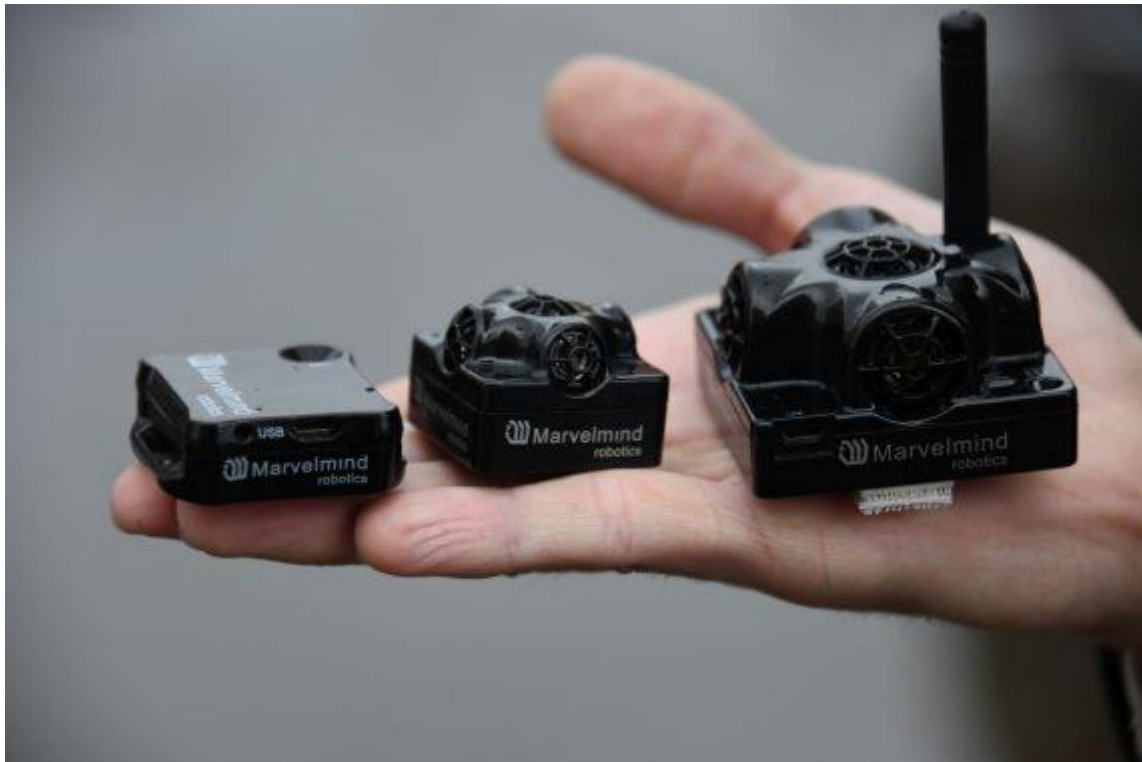
Joonis 4. HW 4.9 saatja (paremal), Mini-TX saatja (keskel) ja ainult IA arhitektuuri toetav Mini-RX vastuvõtja (vasakul).
